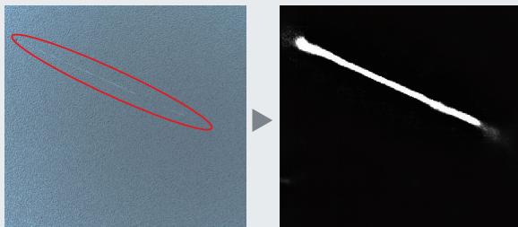
噴砂加工金屬上的刮痕
