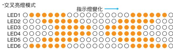
\* 2. 本產品可在區域指示模式下切換為全部閃爍/來回亮燈/交叉亮燈，同時還可在外部區域指示模式下切換閃爍速度。閃爍速度依顯示模式而定。
